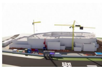
施工场地布置模型-LOD300
