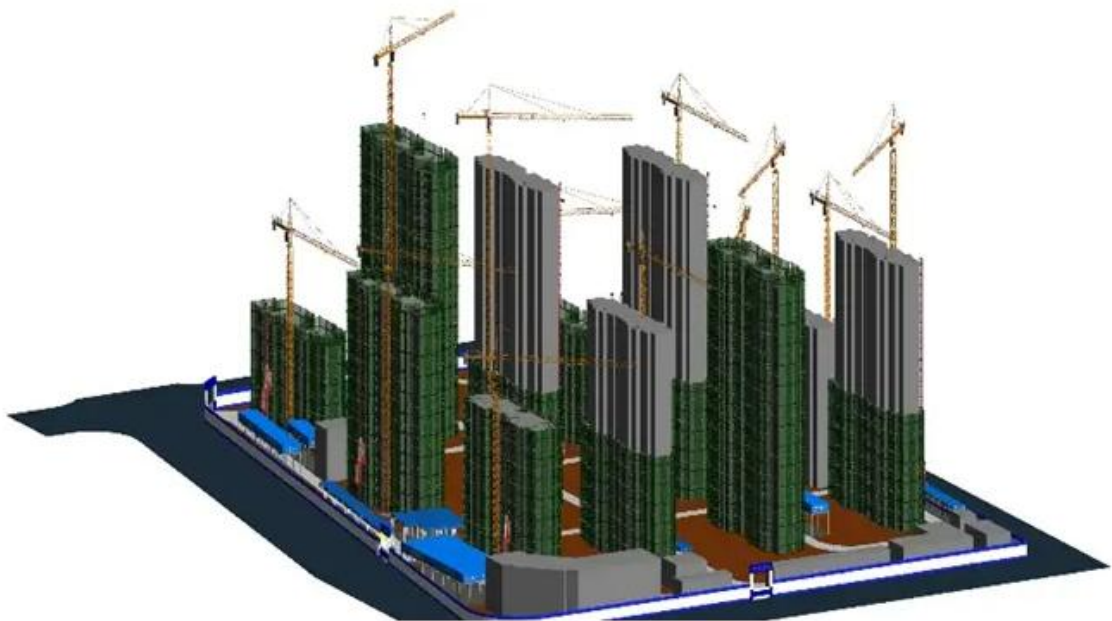
BIM 施工阶段模型
